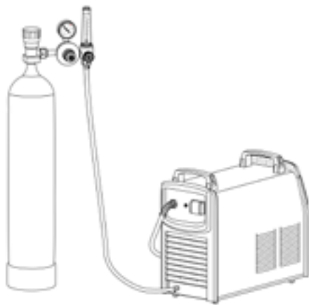
Рисунок 8.4. Подключение защитного газа.
