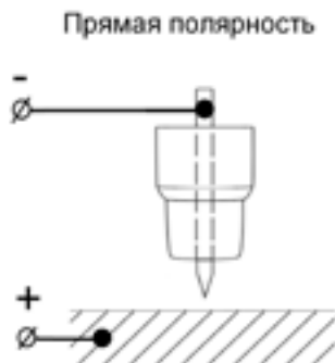
Рис. 8.5. Полярность при TIG сварке.
