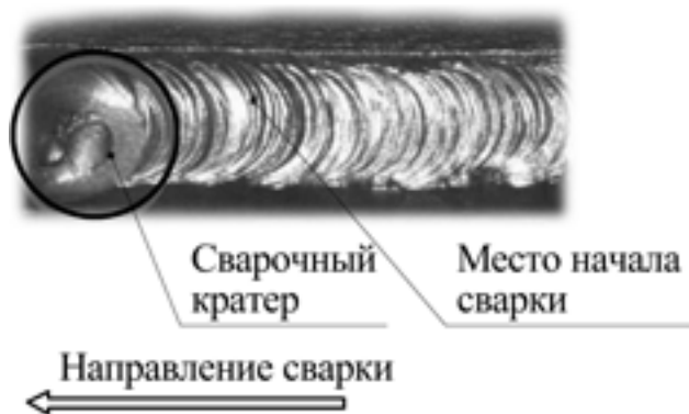
Рис. 9.4. Начало сварки при смене электрода.
